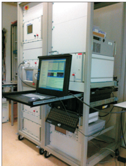
Rys. 1. Wykorzystany symulator sygnałów nawigacyjnych systemów satelitarnych Spirent GSS7700/7800
