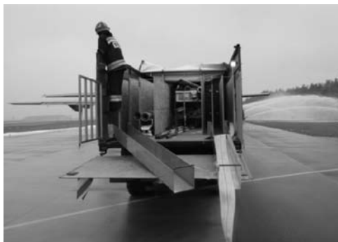
Rys. 6. Sprawianie linii zasilającej W110 z samochodu wężowego wyposażonego w koryta pionowe
