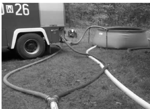
Rys. 7. Przepompowywanie z wykorzystaniem zbiornika zewnętrznego
