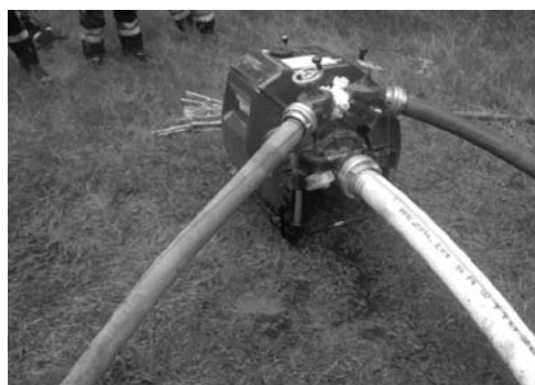
Rys. 8. Przetłaczanie przy pomocy motopompy M16/8
