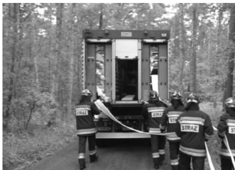
Rys. 5. Sprawianie linii zasilającej W110 z samochodu wężowego wyposażonego w półki
