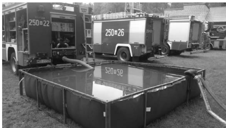
Rys. 13 Zbiorniki magazynowe na wodę
