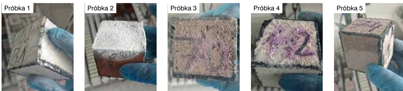
Rys. 3. Zdjęcia próbek wykonane po ukończeniu 15 cyklu oddziaływania mgły solnej
