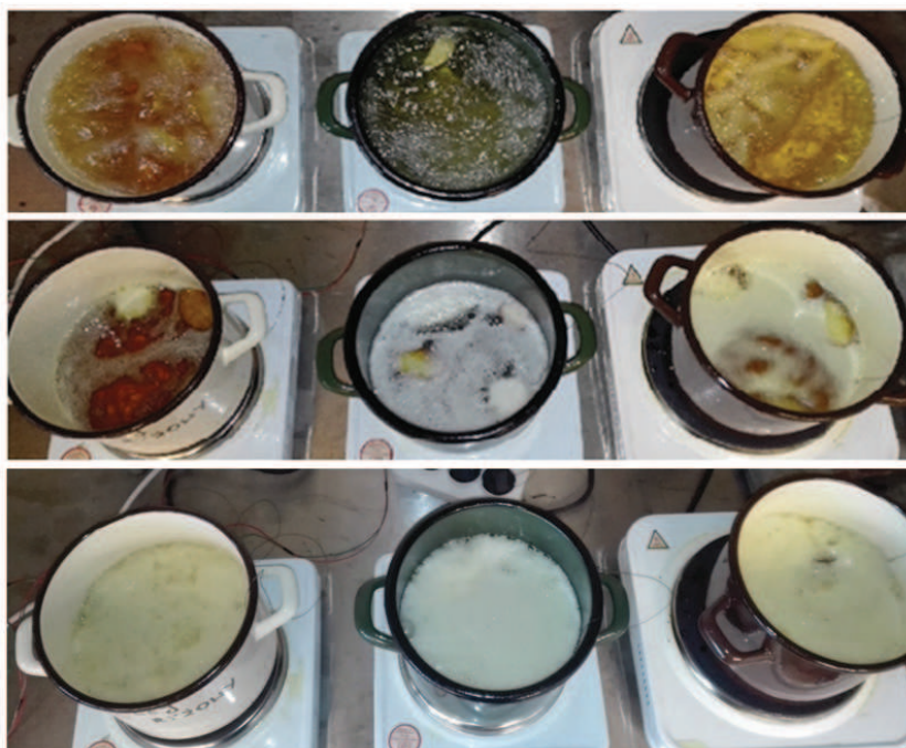
Rys. 5. Tworzenie się piany podczas smażenia. Od lewej kolejno: olej ryżowy, słonecznikowy i rzepakowy. Zdjęcia przedstawiają od góry: smażenie na świeżym oleju oraz po 10 i 30 godzinach pracy
