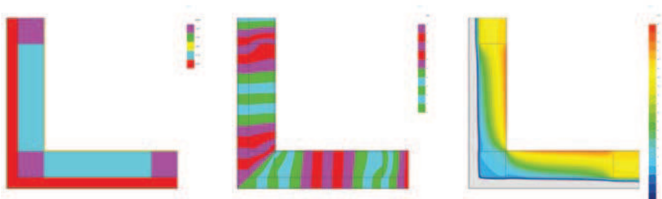
Rys. 4. Przykładowe graficzne przedstawienie wyników symulacji komputerowej dla narożnika ściany dwuwarstwowej niejednorodnej cieplnie – opracowanie własne: a) model obliczeniowy, b) linie strumieni ciepłych (adiabaty), c) rozkład temperatur (izotermy)
