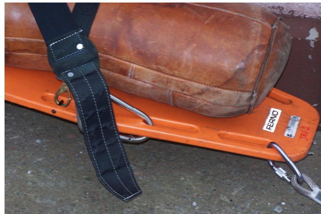
Fot. 8. Element zamocowania noszy, zatrzaśnika i pasa strażackiego (zbliżenie)
