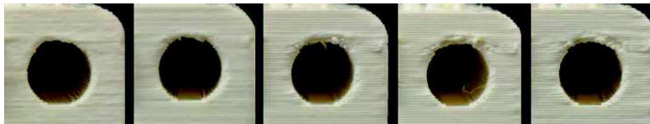
Rys. 7. Zestawienie otworów przelotowych w osi Y w zależności od prędkości: 5 mm·s -1 , 30 mm·s -1 , 60 mm/s, 90 mm·s -1 , 120 mm·s -1
