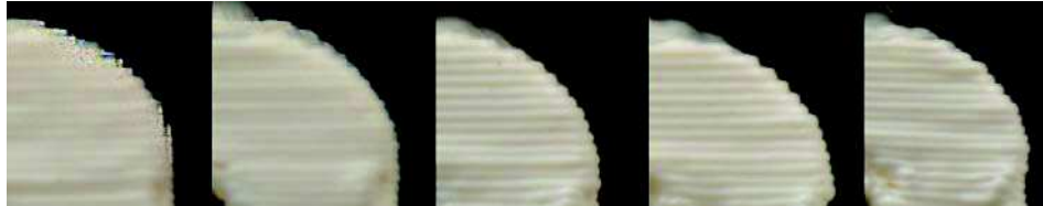
Rys. 12. Chropowatość na powierzchniach promieni wypukłych w zależności od prędkości ruchu głowicy: 5 \text{ mm}\cdot\text{s}^{-1} , 30 \text{ mm}\cdot\text{s}^{-1} , 60 \text{ mm}\cdot\text{s}^{-1} , 90 \text{ mm}\cdot\text{s}^{-1} , 120 \text{ mm}\cdot\text{s}^{-1}
