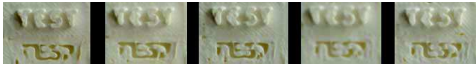
Rys. 18. Jakość tekstu wklęsłego i wypukłego w zależności od prędkości głowicy: 5 mm·s -1 , 30 mm·s -1 , 60 mm·s -1 , 90 mm·s -1 , 120 mm·s -1
