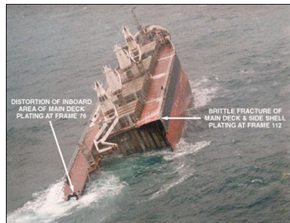
Rys. 7. Statek tonący z powodu przełamania się w sztorcie na skutek korozji kadłuba [5]
