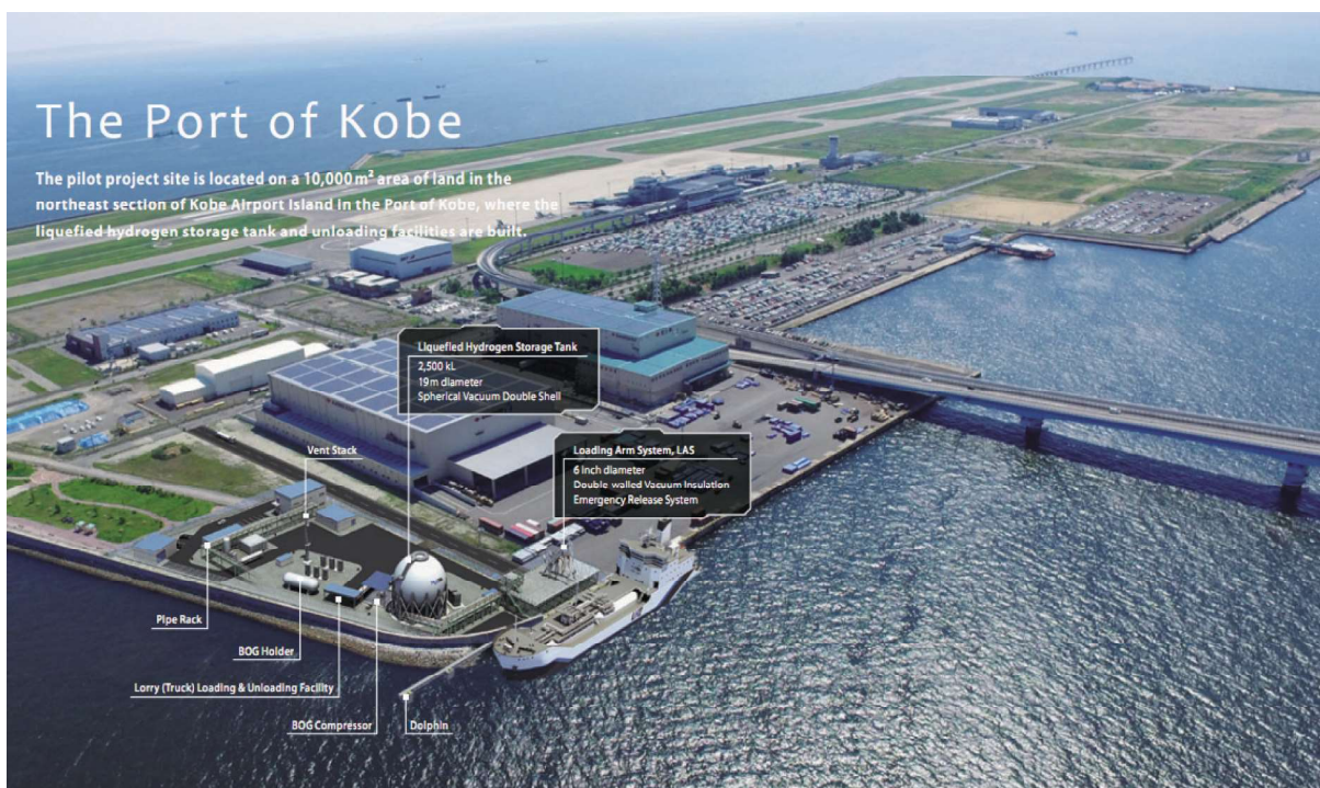
Rys. 6. Wizualizacja instalacji do rozładunku skroplonego wodoru w porcie w Kobe w Japonii ( http://www.hystra.or.jp/en/outline/ )
