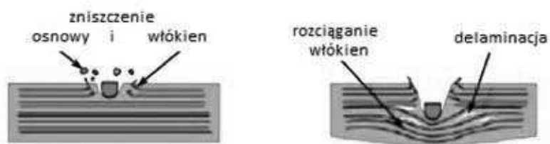
Rys. 3. Mechanizm dyssypacji energii uderzenia w procesie niszczenia kompozytu a) faza I – zniszczenie włókien i osnowy, b) faza II – delaminacja matrycy i rozciąganie włókien [7]
