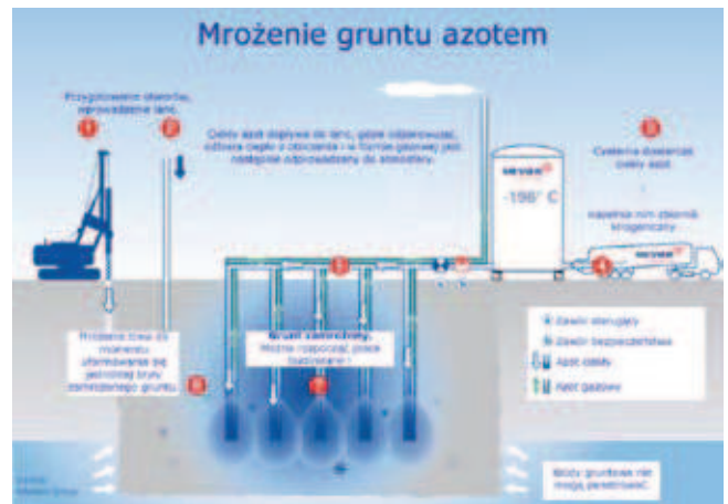
Rys. 9. Technologia mrożenia gruntu azotem (źródło: Messer)
