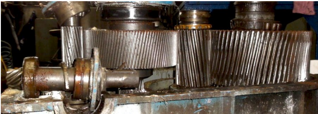
Rys. 35.1 Przekładnia podczas demontażu
