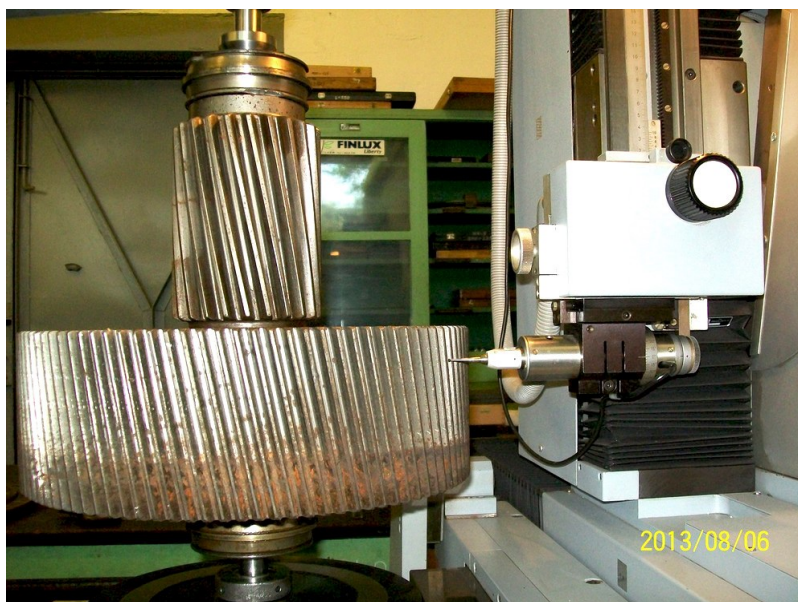
Rys. 35.2 Pomiary zużytych elementów przekładni
