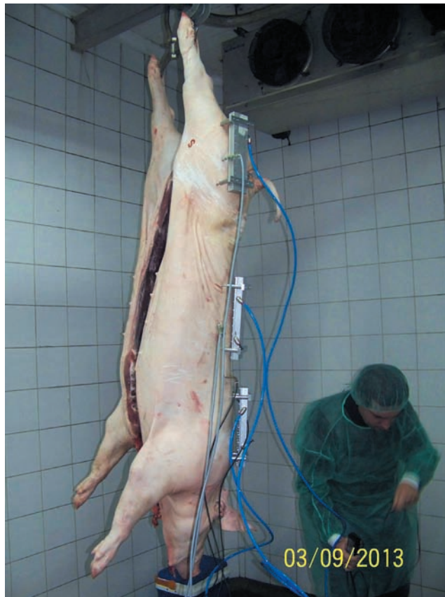
Rysunek 4 Zdjęcie półtuszy wieprzowej z zamocowanymi głowicami mikrostrumieniowymi
