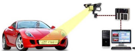
Rys. 4. Sposób identyfikacji pojazdu na podstawie tablicy rejestracyjnej
