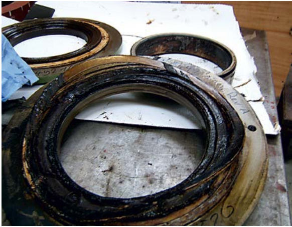
Rys. 10. Uszkodzone łożysko generatora Fig. 10. Generator bearing defective
