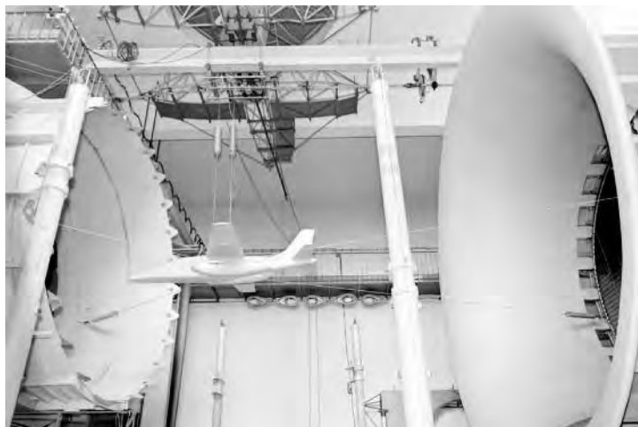
Rys. 4. Model flatterowy samolotu I-22 IRYDA w tunelu aerodynamicznym \varnothing 5m Instytutu Lotnictwa (fot. archiwum ILot)
