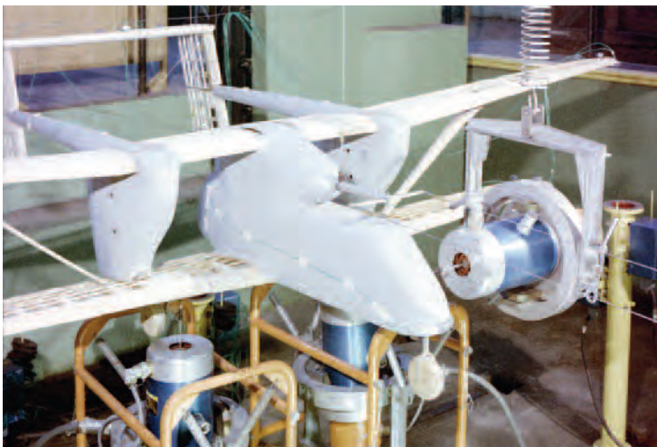
Rys. 2. Model flutterowy samolotu M-15 podczas badań rezonansowych (1976/82, fot. archiwum ILot)
