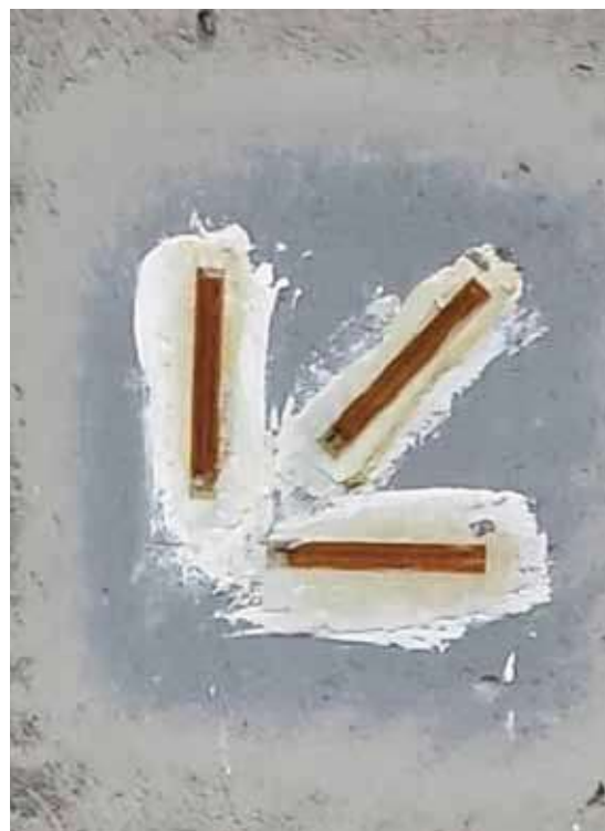
Rys. 2. Powierzchnia przygotowana do badań z przyklejonymi tensometrami
