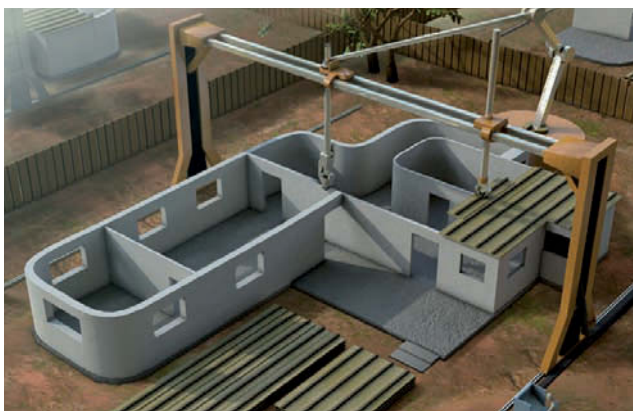
Rys. 3. Zasada działania Contour Crafting [4]
