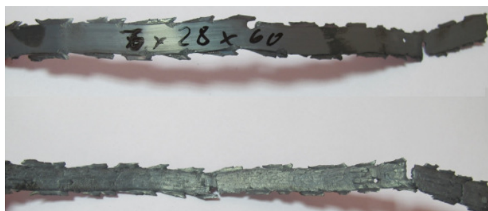
Rys. 5. Wyciśnięty profil, parametry procesu: 28 obr/min, 30 kN, \lambda=8
