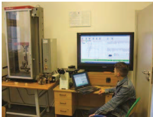
Rys. 1. Stanowisko do badań wytrzymałościowych próbek zdrowego i uszkodzonego drewna jaworowego
