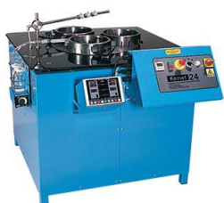
Rys. 2. Widok ogólny docierarki: a) jednotarczowej Kemet 24 [7], b) dwutarczowej AC microline 1000 firmy Peter Wolters [6]
