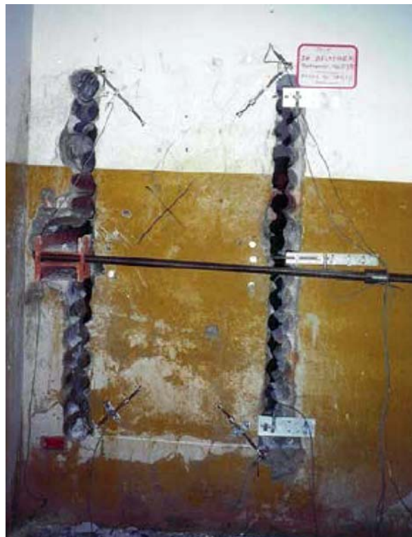
Ryc. 10. Próba ścinania-kompresji bez kontrolowanego ściskania, tzw. próba Shepparda [18]
