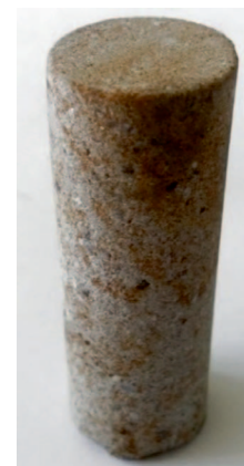
Fot. 1. Rdzeń wycięty z próbki piaskowca
