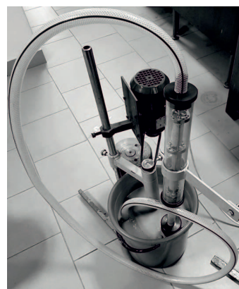
Fot. 3. Symulator przepływu cieczy wiertniczych (Kremieniowski et al., 2018)
