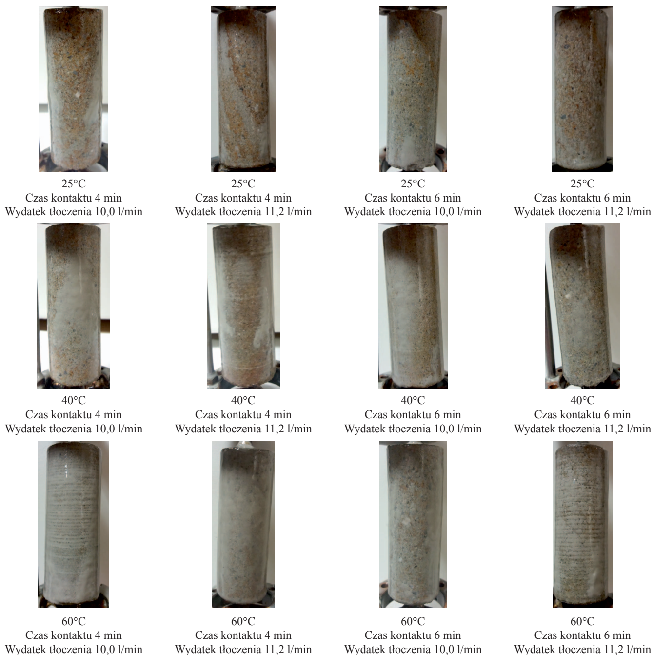
Fot. 4. Rdzenie piaskowca przemyte z osadu płuczkowego za pomocą cieczy przemywającej (płuczka beziłowa z blokatorami)
