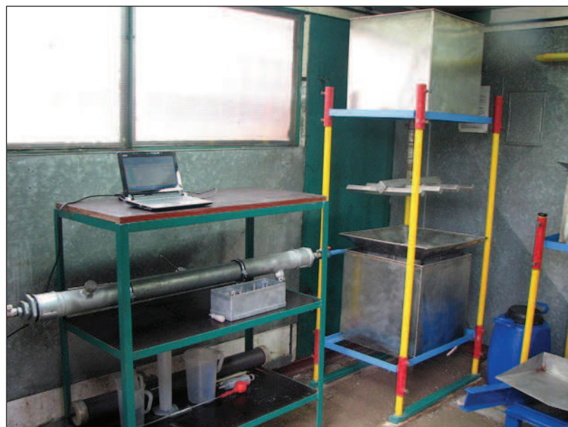
Fot. 4. Stanowiska badawcze(po lewej stronie): do monitorowania mikrośrodowiska w instalacjach wodociągowych (PE). Wynalazek opublikowany w: Biuletynie Urzędu Patentowego z dnia 10.09.2012 r., nr 19(1010)/2012, fot. Z. Staszewski, 2013r.
