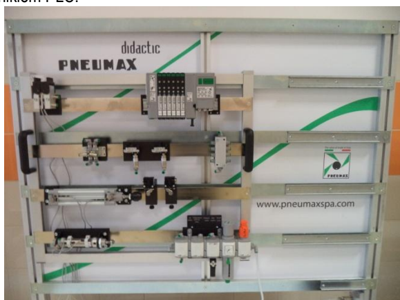
Rys. 3. Panel pneumatyczny kontrolowany sterownikiem PLC
