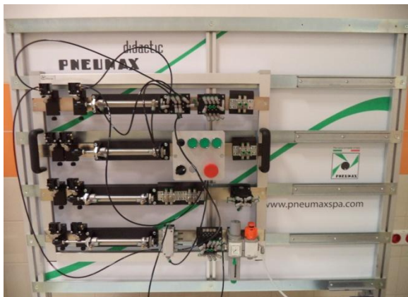
Rys. 6. Układ „Sterowanie siłownikiem podwójnego działania z wykorzystaniem rozdzielacza bistabilnego oraz modułu z przyciskami pneumatycznymi” połączony na panelu pneumatycznym.
