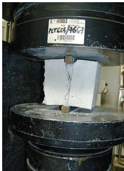
Rys. 3. Zniszczona próbka po badaniu wytrzymałości na rozciąganie
