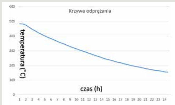
Wykres nr 1. Krzywa odprężania wyrobów szklanych w odprężarce komorowej nr 1.
