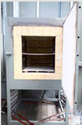
Fot. 2. Odprężarka komorowa elektryczna, Centrum Szkła i Ceramiki.
