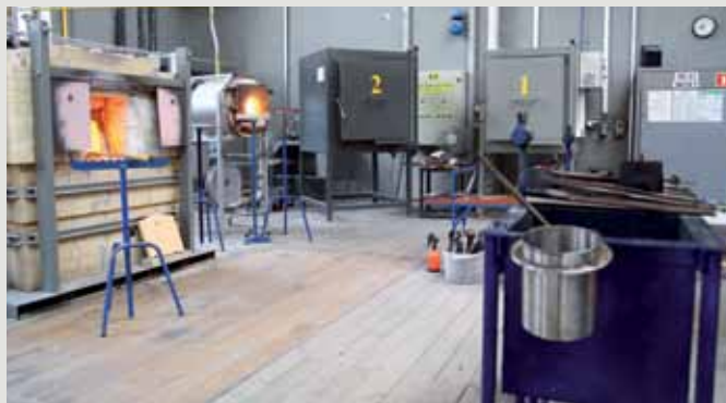
Fot. 1. Podest hutniczy w Centrum Szkła i Ceramiki w krakowskim Oddziale Instytutu Ceramiki i Materiałów Budowlanych. Widoczne dwie odprężarki komorowe (1, 2).
