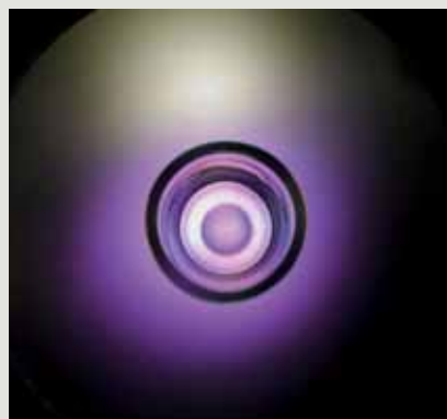
Fot. 4. Kubeczek szklany – widok w świetle spolaryzowanym w trakcie badania polaryskopo-polarymetrem PKS-250.
