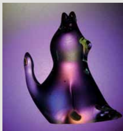
Fot. 6. Figurka – widok w świetle spolaryzowanym w trakcie badania polaryskopo-polarymetrem PKS-250.
