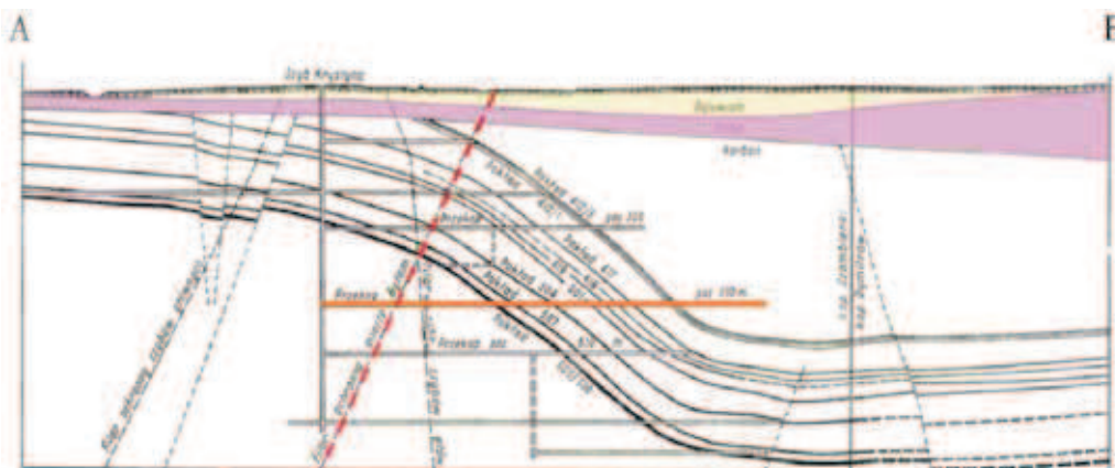
Rys. 2. Schematyczny przekrój geologiczny przez filar ochronny (południe-północ) [2], lokalizację przekroju przedstawiono na rys. 1 i 3
