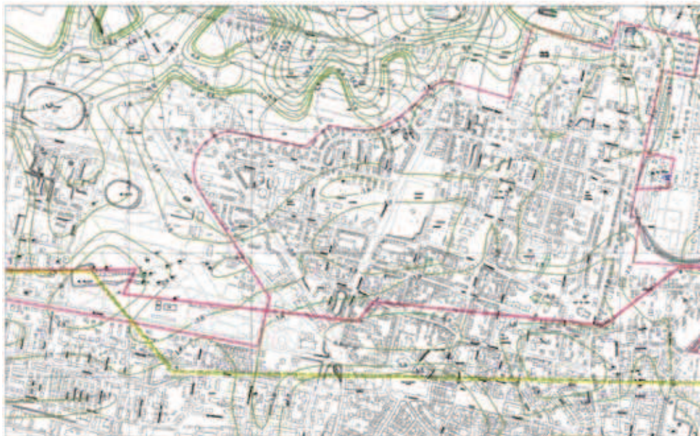
Rys.11. Obliczone minimalne odkształcenia poziome (o charakterze ściskania) terenu Fig. 11. Calculated minimum horizontal strains (compression) of the area
