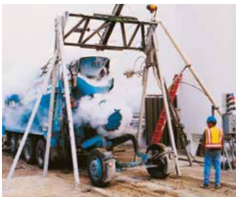
Fot. 1. Urządzenie do rozdrabniania brył lodu i do dozowania bezpośredniego do bębna betonomieszarki samochodowej [14]
