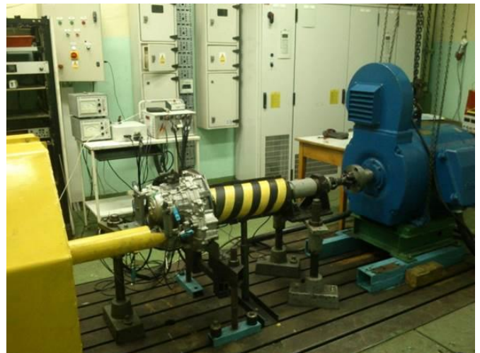
Rys. 6. Stanowisko badawcze bezstopniowej przekładni z prototypowym układem hydraulicznym
