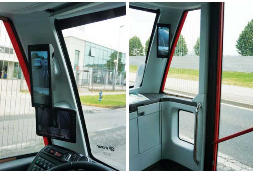
Monitory zamontowane przy słupkach „A”, które zastąpiły klasyczny system lusterek
