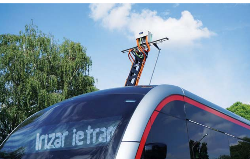
Baterie HighPower ładowane są głównie za pomocą pantografu zamontowanego w przedniej części pojazdu
