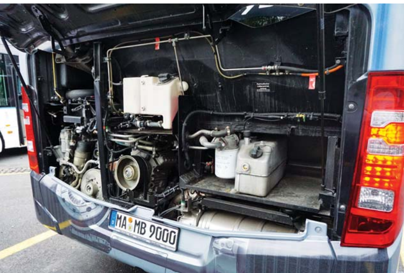
Pierwotnym źródłem energii w hybrydowej wersji Citaro jest silnik OM 936 LA o pojemności 7,7 dm 3
