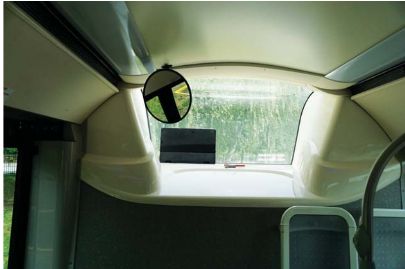
Tylna szyba zachodzi aż na powierzchnię dachu, doskonale doświetlając wnętrze przestrzeni pasażerskiej
