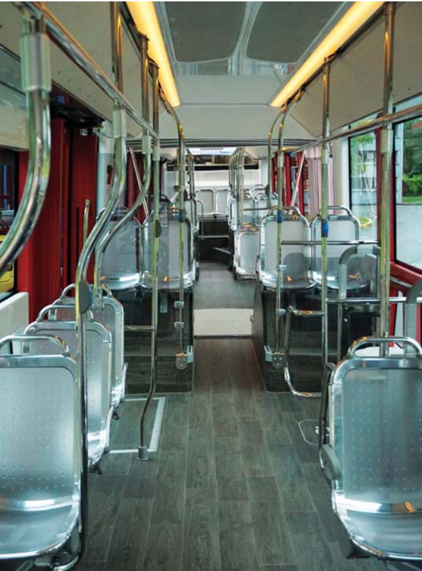
Wnętrze iE-tram pozbawione jakichkolwiek podestów
