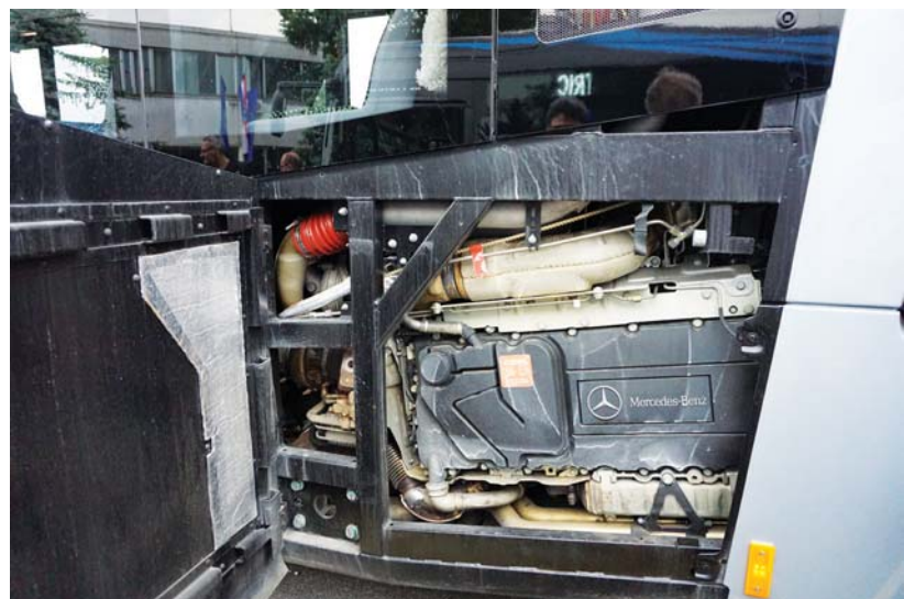
Silnik elektryczny został umieszczony pomiędzy silnikiem a automatyczną skrzynią biegów
