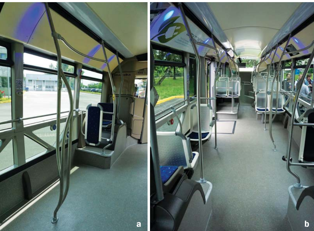
Przestrzeń pasażerska: a) ciekawe ukształtowanie poręczy, zrywające z prostoliniowym podziałem przestrzeni we wnętrzu, b) układ siedzeń
