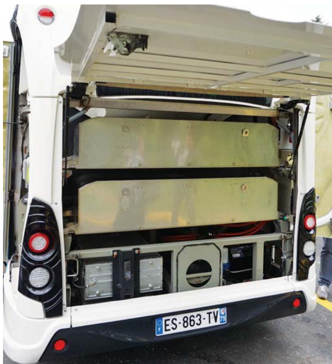
Baterie zajmują niemal całą objętość komory usytuowanej na zwisie tylnym. Pozostałe baterie ulokowano w środkowej części dachu
