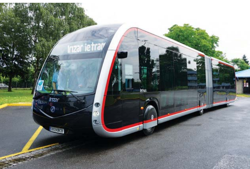
Wyróżniającymi się elementami nowego pojazdu są mocno pochylona szyba przednia i brak lusterek zewnętrznych
