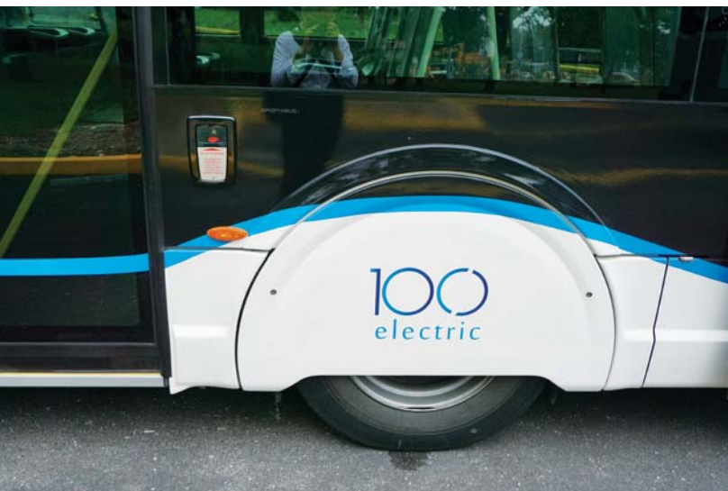
Dodatkowy poziomy podział płaszczyzny ścian bocznych umożliwia szybką wymianę uszkodzonych elementów nadwozia w wyniku drobnych przytarć
