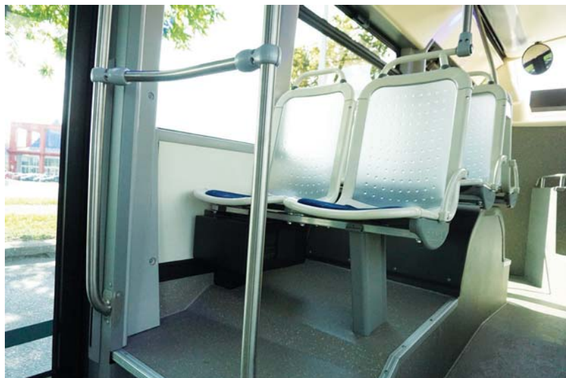
Dziwny jest fakt, że część foteli w GX 337 E została zamontowana na podporach mocowanych bezpośrednio do podłogi
