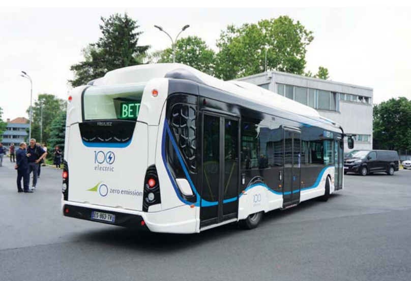
Tylna część nadwozia. Dzięki dużej liczbie pokryw przeglądowych GX 337 E charakteryzuje się łatwym dostępem do podstawowych komponentów
