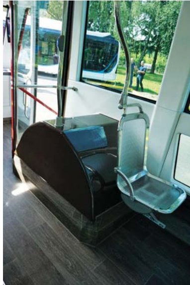
Niezagospodarowana przestrzeń ponad przednim prawym nadkolem
