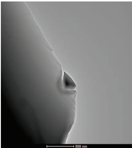
Ryc. 9. Próbką K1 – zaburzenia na granicy ziaren. Obrazowanie transmisyjne (TEM)
