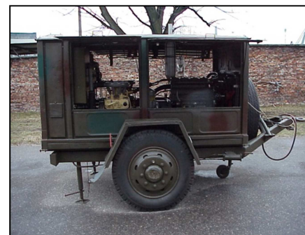
Rys. 7. Zestaw zasilania bazy zabezpieczenia prac podwodnych "ORTOLAN" wraz ze sprężarkami powietrza nurkowego EK 2-150 produkcji ZSRR.
