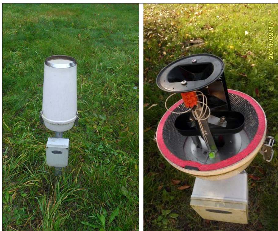
Rys. 2. Deszczomierz typu TPG-036-H24 firmy A-STER [1]
