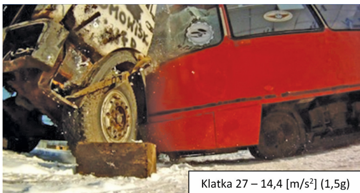
Fot. 4. Poklatkowa analiza obrazu zderzenia tramwaju poruszającego się w chwili zderzenia z prędkością 40 km/h z samochodem ciężarowym
