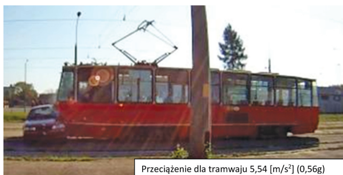
Fot. 3. Poklatkowa analiza obrazu zderzenia tramwaju poruszającego się w chwili zderzenia z prędkością 36 km/h z samochodem osobowym
