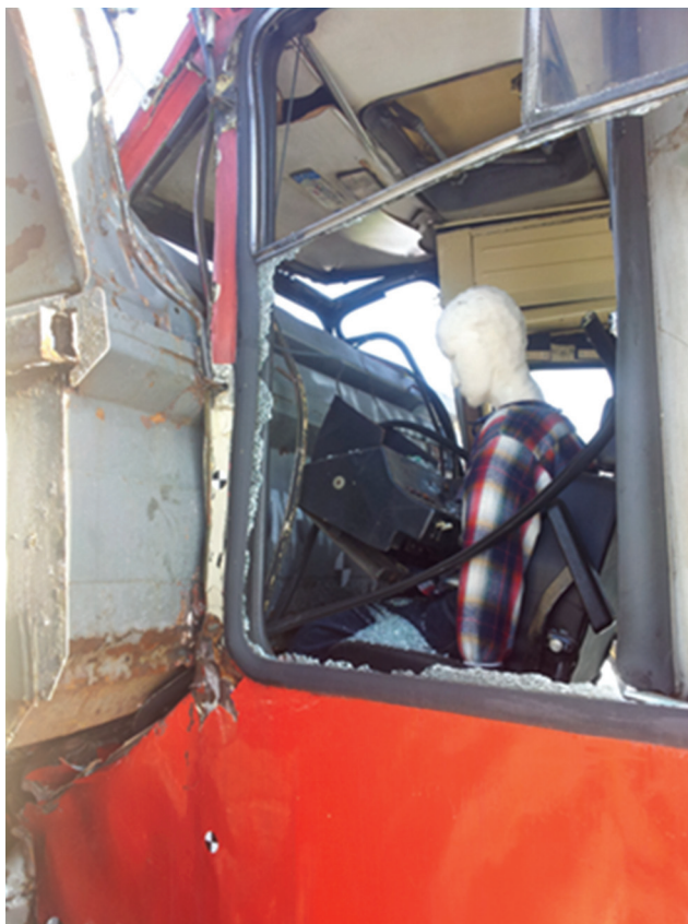
Fot. 2. Skutki zderzenia tramwaju z samochodem ciężarowym – widok z boku i przodu
