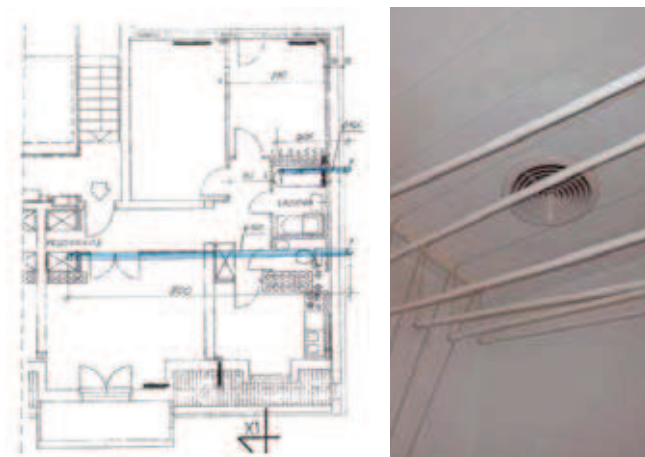
Rys. 13. Pseudowentylacja grawitacyjna za pomocą rur spiro prowadzonych poziomo przez 2 m z łazienki i przez 8 m z przedpokoju
