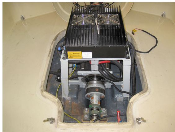
Rys. 2. Widok stelaża z ładowarką, silnikiem i sprzęgłem podatnym skrętnym
