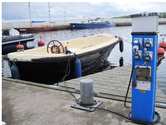
Rys. 1. Widok łodzi podczas ładowania pakietu akumulatorów
