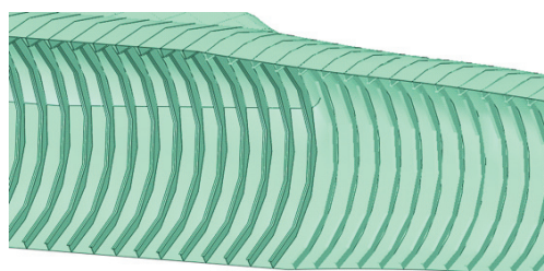
Rys. 6. Usztywnienia okrętu (lewa strona — powłokowe, prawa — belkowe) [4]
