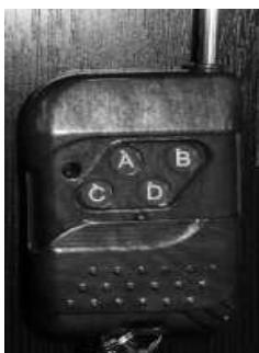
Rys. 3. Nadajnik kanału dla informacji o wykryciu przeszkody
