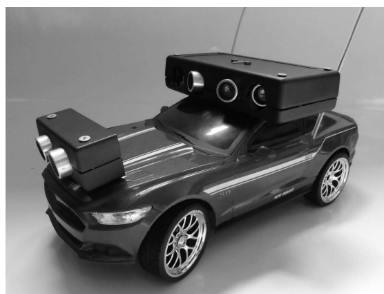
Rys. 6. Widok modelu pojazdu z trzema ultradźwiękowymi czujnikami odległości
