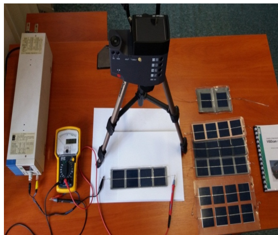
Rys. 11. Stanowisko do badań ogniw słonecznych z wykorzystaniem kamery termowizyjnej
