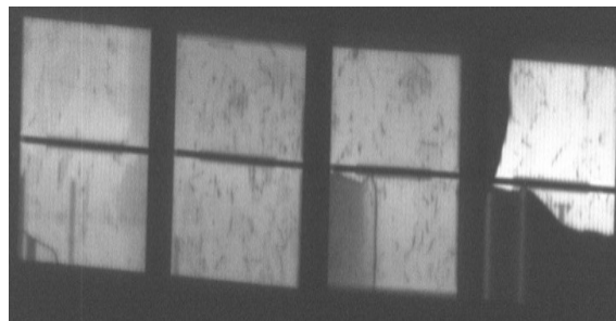
Rys. 10. Obraz elektroluminescencji pokrycia EPF_02 i EPF_05
