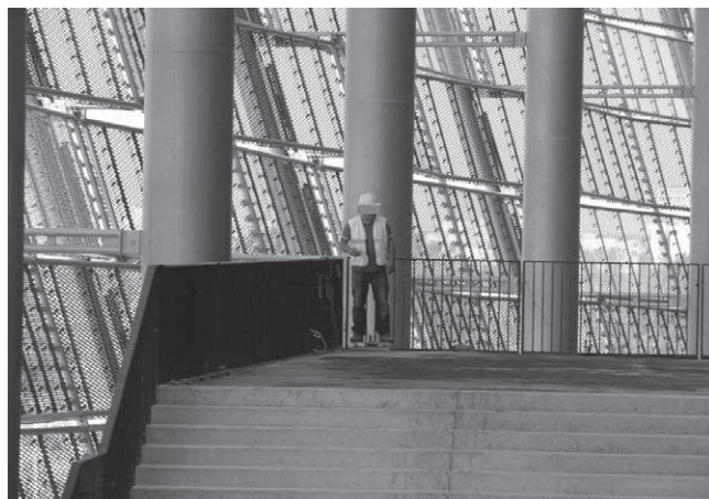
Rys. 6. Widok górnego spocznika w czasie próbnego obciążenia dynamicznego: podskoki 1 osoby na górnym spoczniku (fot. R. Czachowski)
