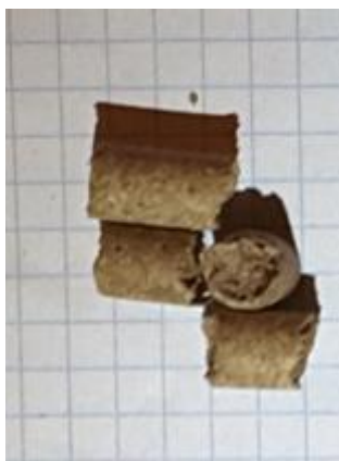
Rys. 3.1.2. Brykiety z biomasy leśnej z 20% dodatkiem DEPOL 40.
