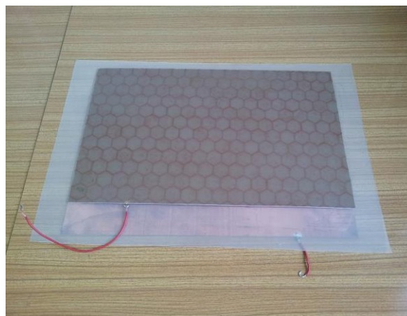
Rys. 3 Sposób wykonania elementu pojemnościowego ( C \approx 10,5 \text{ nF} )
