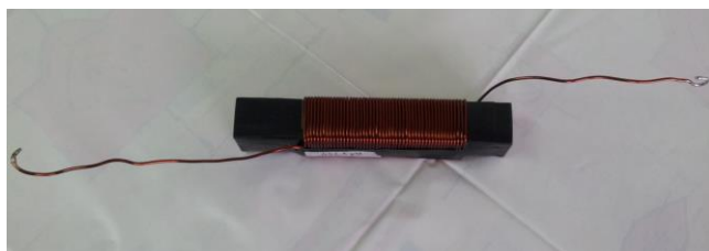
Rys. 2 Sposób wykonania elementu indukcyjnego ( L \approx 460 \mu\text{H} )
