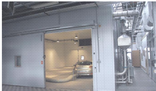
Rys. 4. Laboratorium Emisji Spalin w Instytucie Badań i Rozwoju Motoryzacji BOSMAL – komora klimatyczna
