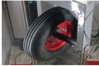
Rys. 8. Widok stanowiska do oceny ściskania koła pomiarowego wykorzystanego w urządzeniu CSR
