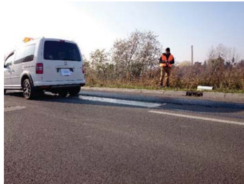
Rys. 10. Pomiary urządzeniem CSR, a) najazd na odcinek śliski, b) pomiary w warunkach „na mokro”
