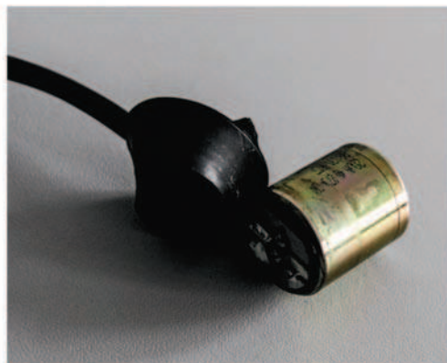
Rys. 6. Widok hydrofonu MP 24 L1 – 6Hz produkcji Geospace Fig. 6. MP 24 L1 – 6Hz Geospace hydrophone
