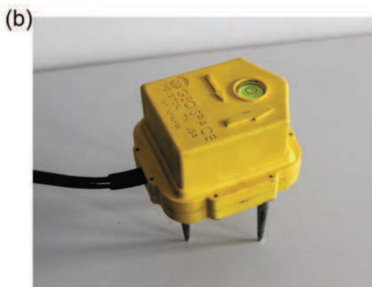
Rys. 5. Widok geofonu pionowego 20DM - 40Hz produkcji Geospace – a i trójskładowego produkcji 11D - 4,5Hz produkcji Geospace – b
