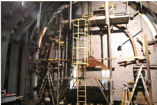
Fot. 2. Odrzwia ŁPw w stanowisku badawczym w trakcie badania
