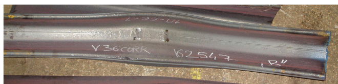
Fot. 1. Kształtownik po próbie zginania „dnem w dół” (u góry) i „dnem w górę” (u dołu)
