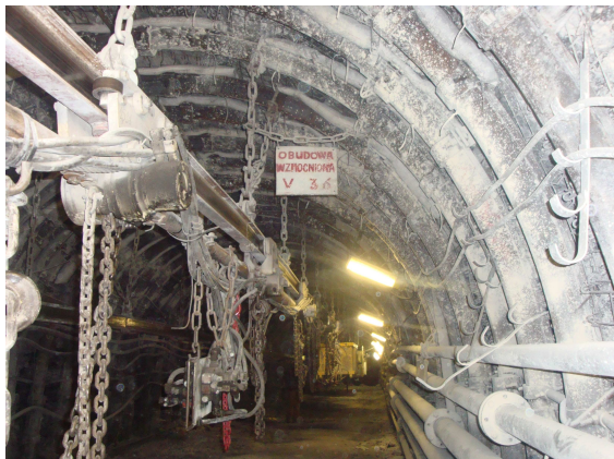
Fot. 4. Obudowa o podwyższonych parametrach mechanicznych II generacji zabudowana w chodniku nadścianowym ściany 6/VI/385, w pokładzie 385 w LW „Bogdanka” SA (Kuziak i in. 2012)
