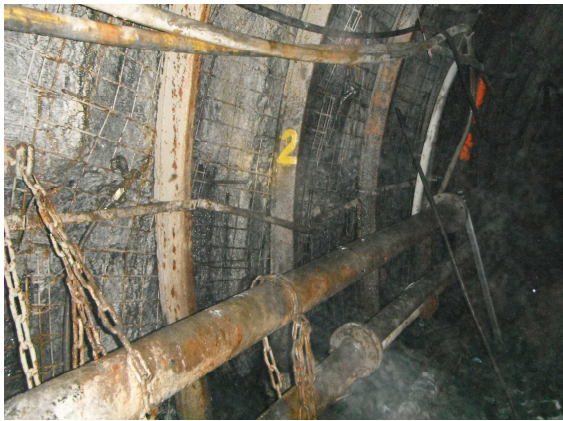
Fot. 3. Odrzwia ŁPw zabudowane w dowerzchni 3 badawczej w pokładzie 504 w kopalni „Bobrek-Centrum” (Kuziak i in. 2012)
