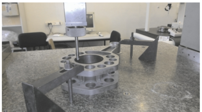
Rys. 9. Pomiar równoległości między osią stopy i głową korbowodu na maszynie współrzędnościowej WMP
