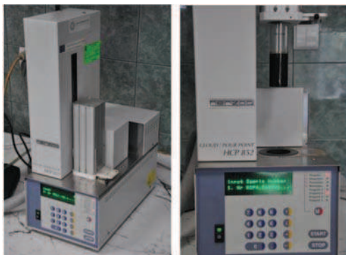
Rys. 3. Aparat do badania temperatury krzepnięcia inhibitorów. Autor D. Bęben
