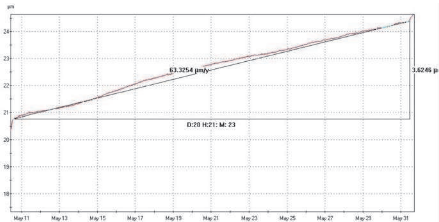
Rys. 7. Wskazania sondy na obiekcie I podczas dozowania inhibitora 1F (test)
