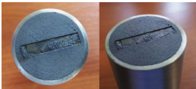
Rys. 9. Fotografie zniszczonej sondy po zakończeniu testów inhibitora 1F firmy B. Autor A. Gliński
