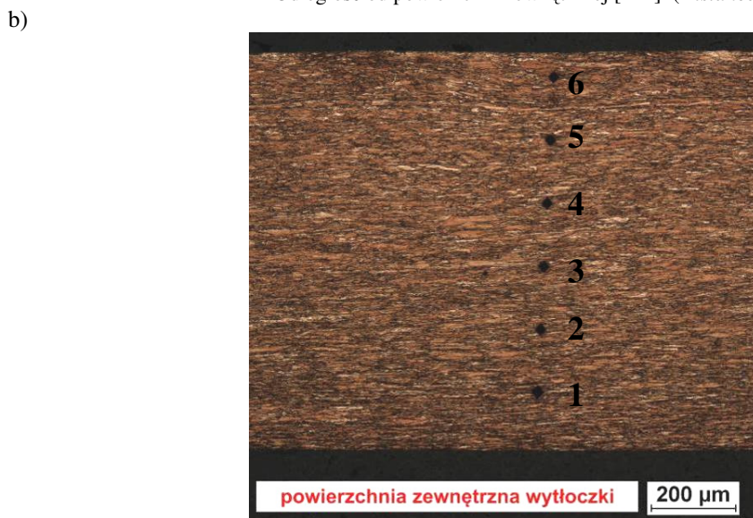
Rys. 15. Rozkład mikrotwardości HV 0,5 na grubości próbki 3
