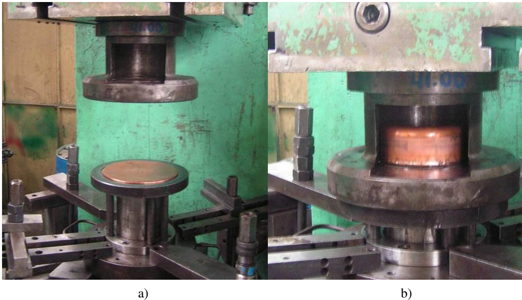
Rys. 1. Tłocznik badawczy do tłoczenia wyłoczek cylindrycznych zamontowany na prasie PHYE-250; a) z widocznym krążkiem wyjściowym do prób tłoczenia założonym na pierścieniu dociskowym, b) z widoczną wytłoczką cylindryczną po operacji tłoczenia
